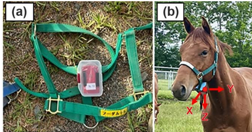
図 1. 本研究で使用した GNSS 一体型 3 軸加速度センサーの外観 (a) と装着時の様子 (b) .
