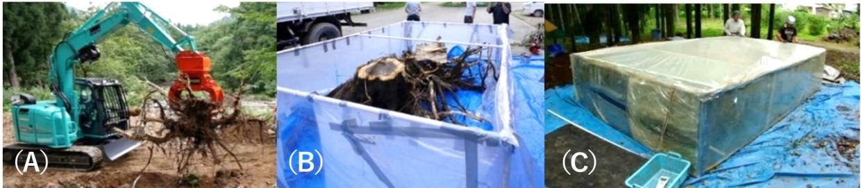
図1. (A) 根全体を重機と人手で徹底的に採取、(B) 全ての根を測定装置に入れる、(C) 密閉後の呼吸測定
