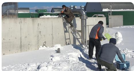
バイオガスプラントの消化液サンプリングの様子
