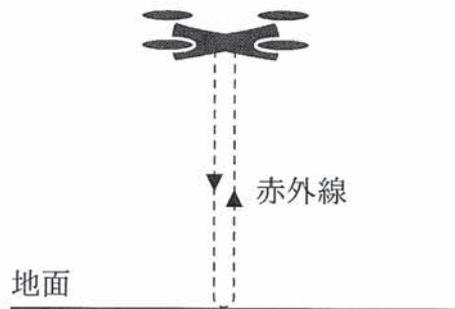
図4 赤外線によるドローンから地面までの距離の測定
