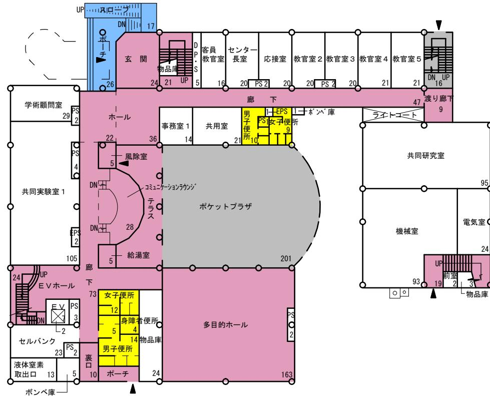
原虫病研究センター 1階平面図 S=1/400
