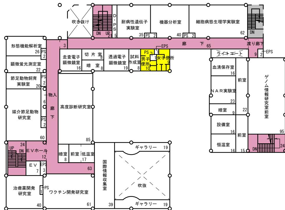
原虫病研究センター 2階平面図 S=1/400
