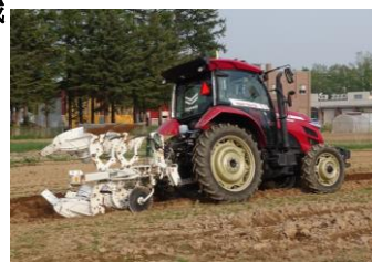
ロボットトラクタに対応した リバーシブル型自動反転装置の開発 (2018年農業技術10大ニュース)
