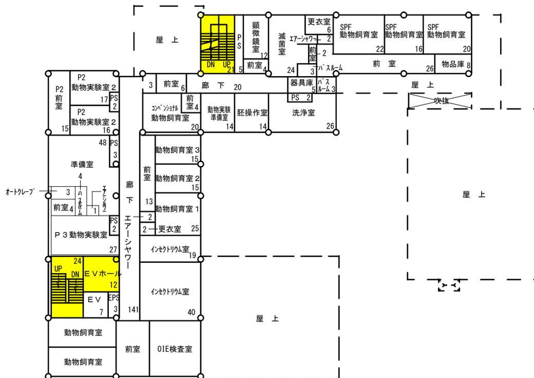
原虫病研究センター 3階平面図 S = 1 / 400
