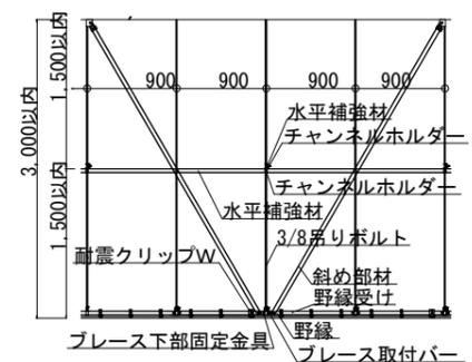
(ブレース(1500mm超 3000mm以下) 野縁直交方向)
