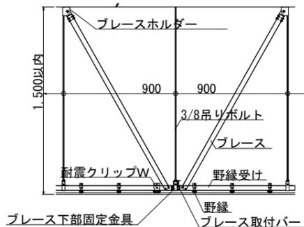
(ブレース(吊長さ1500mm以下) 野縁直交方向)
