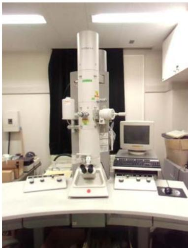
H-7500 形透過電子顕微鏡は医学、生物学に代表されるバイオテクノロジーの研究、開発のみならず新素材、高分子材料研究に対応できる電子顕微鏡です。
