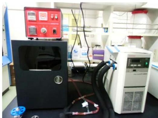
従来のホーン式とは異なり、サンプルをチューブにセットし、超音波水槽内で多検体を同時に処理することができます。サンプルは密閉されたまま超音波水槽内を回転しますので、コンタミネーションの無い、しかも均一な処理を行うことができます。10mL 以上のチューブには、破碎効率をより向上させるため、オートクレーブ可能な共振棒を採用しています。各種細胞の破碎や CHIP assay における chromatin & DNA の断片化に最
