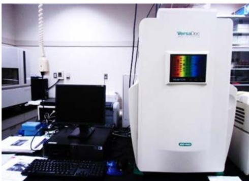
VersaDoc 5000 MP はバイオ・ラッドの化学発光検出装置の中で最も高感度に微弱な光を検出できるタイプになります。バックイlluminate型 CCD カメラを搭載することで、従来のフロントイlluminate型 CCD に比べて量子効率が高く、高感度検出が可能です。また、1 辺が  $24\mu\text{m}$  の巨大な CCD チップを採用していることで、より高感度かつ定量性高く検出することができます。従来の冷却 CCD カメラでは難しかった化学発光法を用いたサザン・ノーザ
