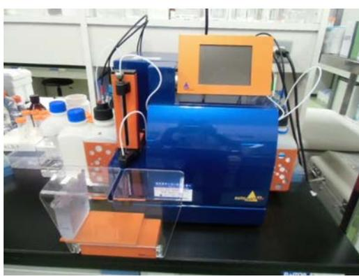
autoMACS Pro Separator はミルテニ-バイオテック社の MACS 技術を利用した、コンピューター制御の自動磁気細胞分離装置です。MACS は微小な磁気粒子の MicroBeads を用いて細胞を磁気標識し、強力な永久磁石の中においた分離カラムに標識した細胞を通すことで細胞を分離します。
