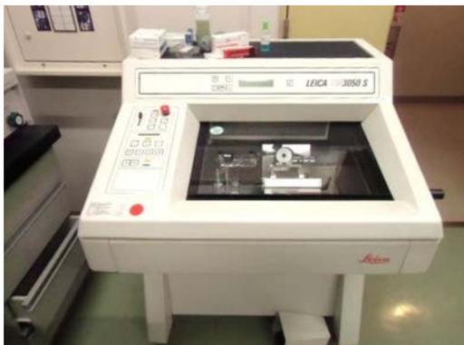
CM3050 の高性能、信頼性をそのまま受けつぎ、さらに機械的な試料送り機構が、ステッピングモーターによる試料送り機構に改良されました。
