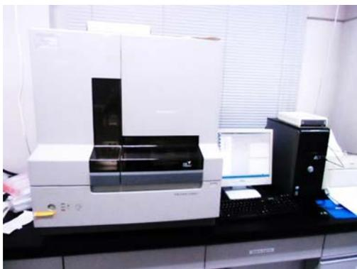
ABI PRISM® 3100 Genetic Analyzer は 16 本キャピラリー電気泳動システム。多色蛍光検出技術だけでなくマルチキャピラリーを組み合わせることにより、310 Genetic Analyzer で実証されている自動化のみならず、処理能力の増加も可能にしました。
