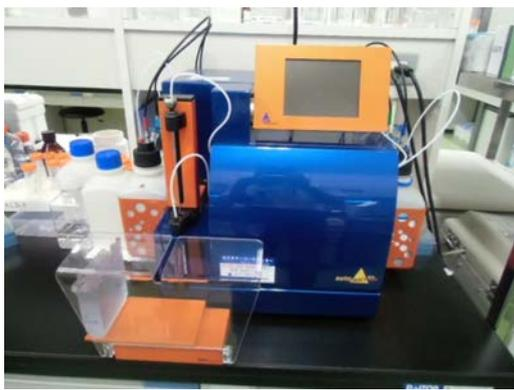
autoMACS Pro Separator はミルテニーバイオテック社のMACS技術を利用した、コンピューター制御の自動磁気細胞分離装置です。MACSは微小な磁気粒子のMicroBeadsを用いて細胞を磁気標識し、強力な永久磁石の中においた分離カラムに標識した細胞を通すことで細胞を分離します。
