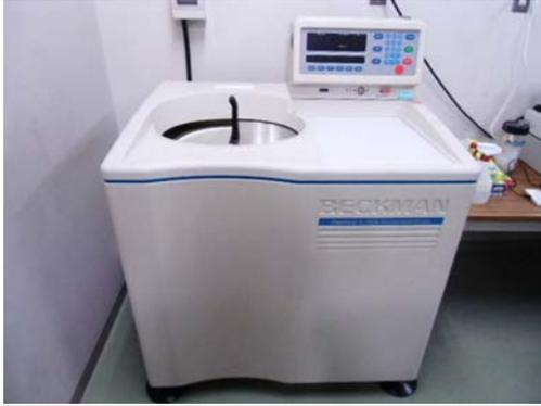
分離用超遠心機の Optima L はジェノミクス、プロテオミクスからセロミクスまですべての研究を強力にサポートします。どなたでも簡単に最適な遠心条件を瞬時に決定し遠心実験を行うことができます。物理的な安全性に加え、サンプルを密封した状態での遠心ツール、運転音の静粛性、使いやすさを追及したデザインで、ベックマン社のすべてのパーティカルチューブ及びスウィングバケット・ロータと共にご使用いただけます。
