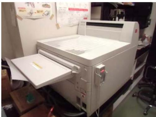
本装置は、暗室自動X線フィルム現像装置に属するものであり、撮影済みのスクリーン型医用X線・画像診断用フィルム、スクリーン型歯科画像診断用X線フィルムを自動現像する装置です。
