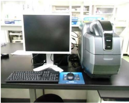
F-OPT 構造。結像光学系と透過照明の光路をミラーで折り返し、さらに落射照明と結像光学系を水平方向に最適な角度に配置することで、高品質な無限遠光学系のまま省スペースを実現しました。位相差スリットの電動切り換え機構搭載。位相差観察時、対物レンズに応じて位相差スリットを連動して自動的に切り換えます。(20 倍⇄40 倍)。
