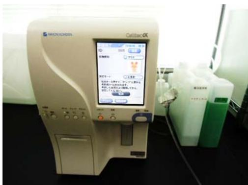
MEK-6450 は、動物種別により、20 項目(犬、猫、牛、馬)または 12 項目(ラット、マウス)の血液を測定できる全自動タイプの動物用血球計数器です。測定は、サンプル管を採血管に挿入してスイッチを押すだけで、すべて自動的に行われます。サンプル管の先端に付着する血液も自動的に洗浄され、操作者は直接血液に触れることなく安心して使用できます。
