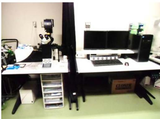
ライカ TCS SP5 は、世界初一つの装置で高速ライブイメージ用ガルバノと通常の高分解能形態イメージ用ガルバノを同時搭載した共焦点顕微鏡です。
