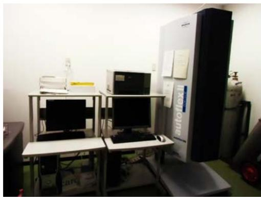
本装置は、簡単な操作で高分子有機化合物、ペプチド、タンパク質、核酸、糖、脂質などの質量を正確に測定することができる質量分析装置である。
