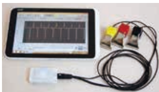
開発した血中Ca濃度解析システムのプロトタイプ
