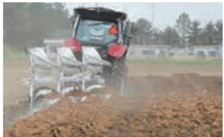
ロボットトラクタに対応するリバーシブルプラウを開発
