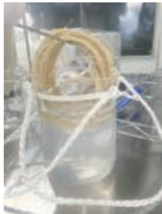
Vectran\_washing:クリーンルームで実験に使う部材(ベクトラン紐)を洗浄している様子。
