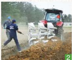
1 トラクターによる無人化作業 2 無人運転でブロー作業を行うトラクター
