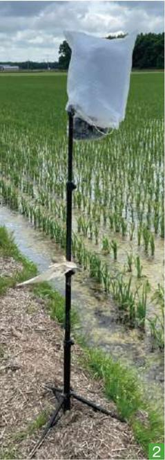
1 越冬中のトウキョウダルマガエルの鳴き声を録音するための設置した集音機器
