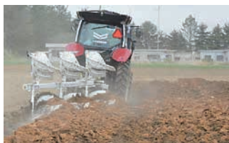
ロボットトラクタに対応するリバーシブルプラウを開発。
