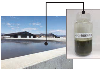
バイオガスプラントにおける消化液
