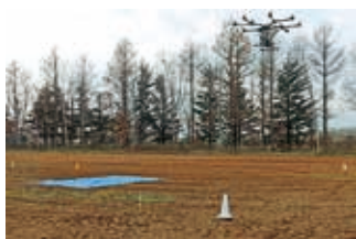
農薬散布用ドローンの散布特性の評価
