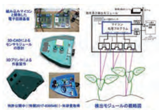
PSDセンサを利用した散布高さ検出モジュールの概要
