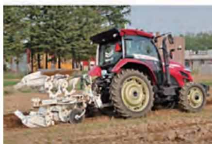
ロボットトラクタによるプラウ耕の完全無人作業
