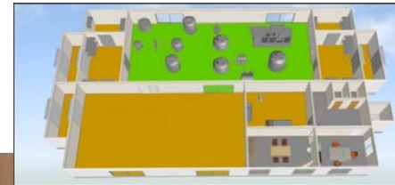
(3Dソフトで作成したHACCP 対応の食品加工施設設計図)
