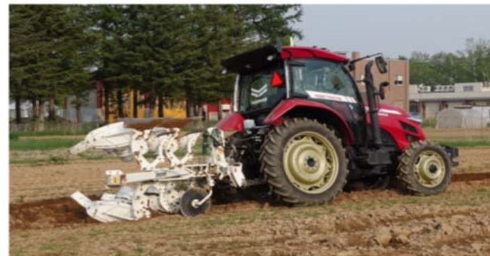
ロボットトラクタによるプラウ耕の完全無人作業
