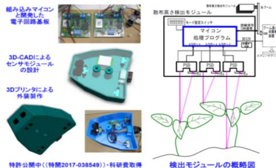
PSDセンサを利用した散布高さ検出モジュールの概要
